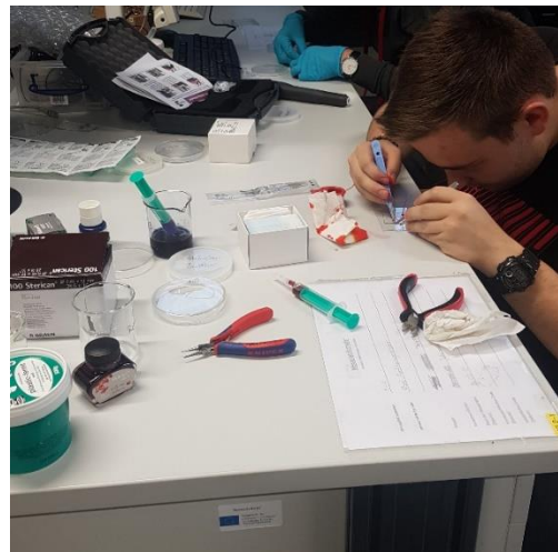
Abb. 1: Zusammenbau der Mikrofluidikchips
