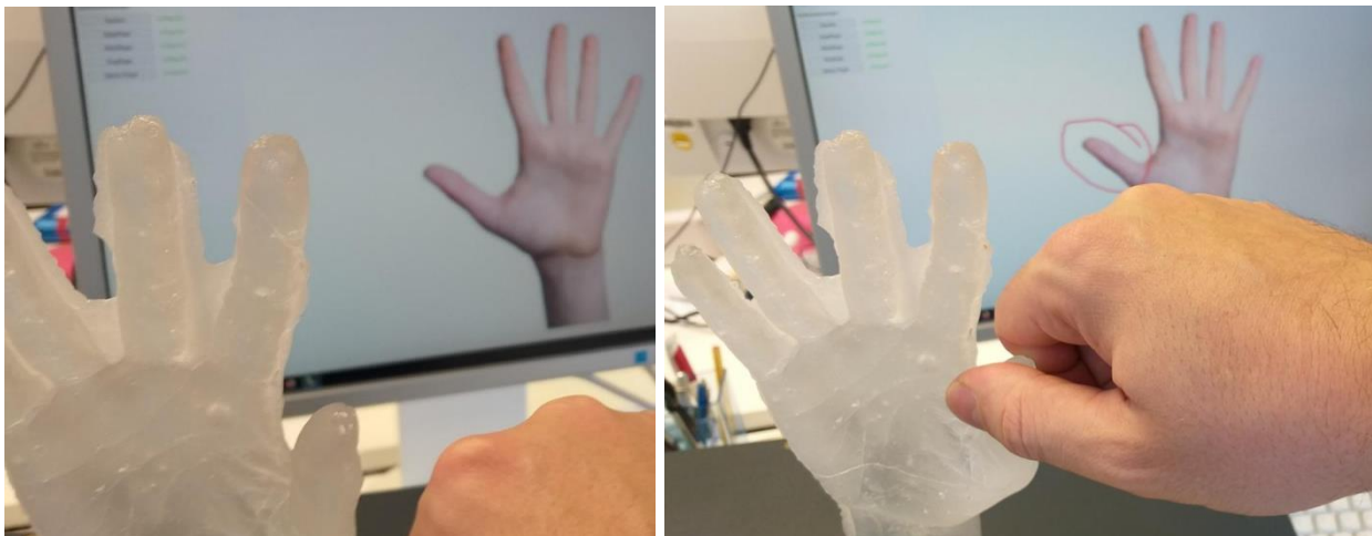
Abb. 1: Glashand mit am Bildschirm visualisierter Darstellung einer Berührung (links: ohne, rechts mit Berührung)
