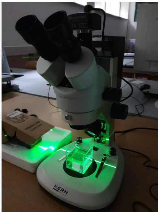
Bild 1: Experimenteller Aufbau des \mu PIV-Systems mit Mikroskop, Kamera und Laser
