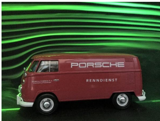
Umströmung eines Modellbusses Foto: Philipp Epple / Michael Steppert
