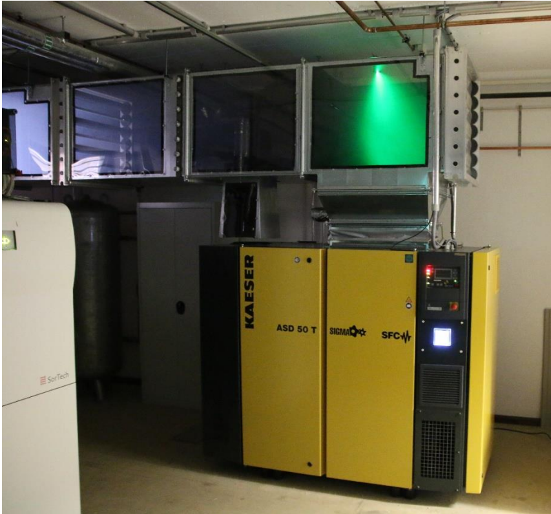
Abb. 2: Abluftkanal mit Laser und Messstellen
