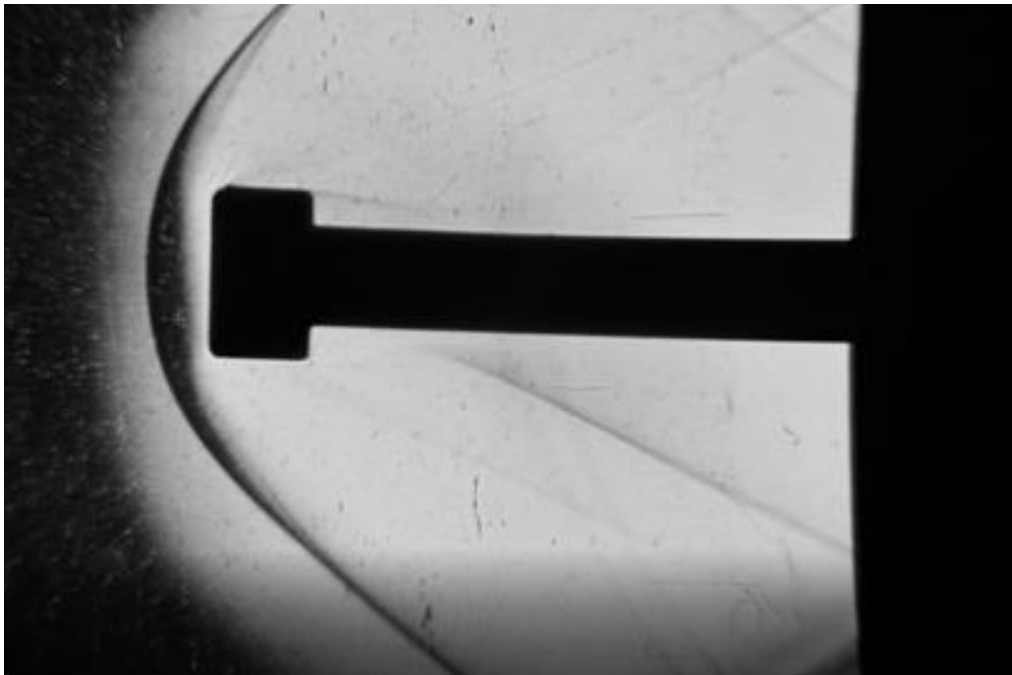
Abbildung 2: Schlierenfotographie eines stumpfen Körpers bei Mach=2
