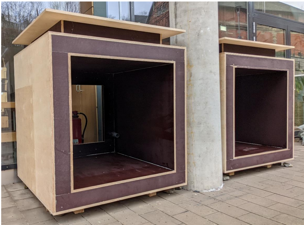
Bild 1: Zwei von vier solarCUBES mit abnehmbarer Frontfassade. Die Frontfassade liegt auf den Kuben.
