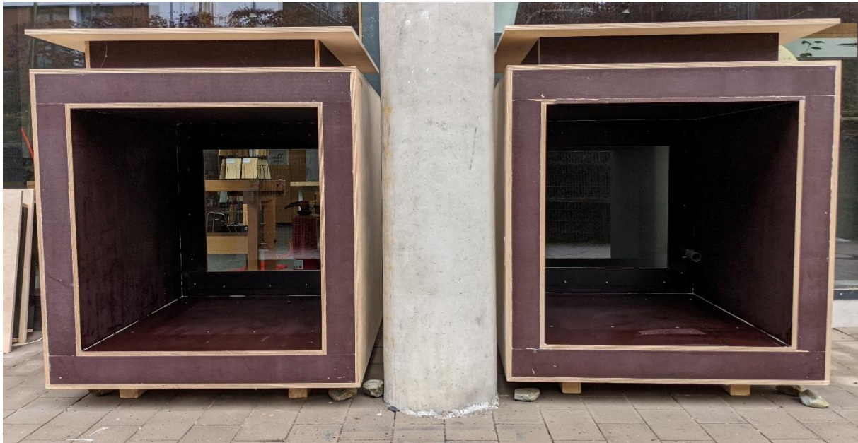
Bild 2: Frontalansicht der solarCUBES. Messung von unterschiedlichen Fassadentypen unter identischen außenliegenden Wetterverhältnissen im Vergleich
