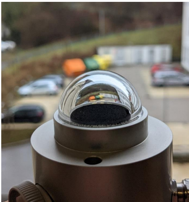
Bild 5: Pyranometer zur Datenerfassung der solaren Einstrahlung Bachelorarbeit Annika Hopf)
