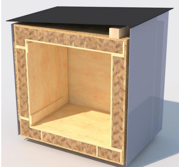
Bild 3: Rendering des solarCUBES mit Darstellung des Schichtaufbaus (Quelle: Bachelorarbeit Annika Hopf)
